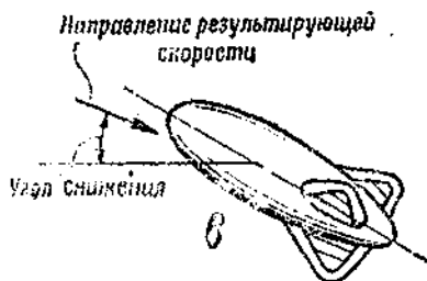
Рис. 56. Изменение высоты аэростата в зависимости от угла снижения:
